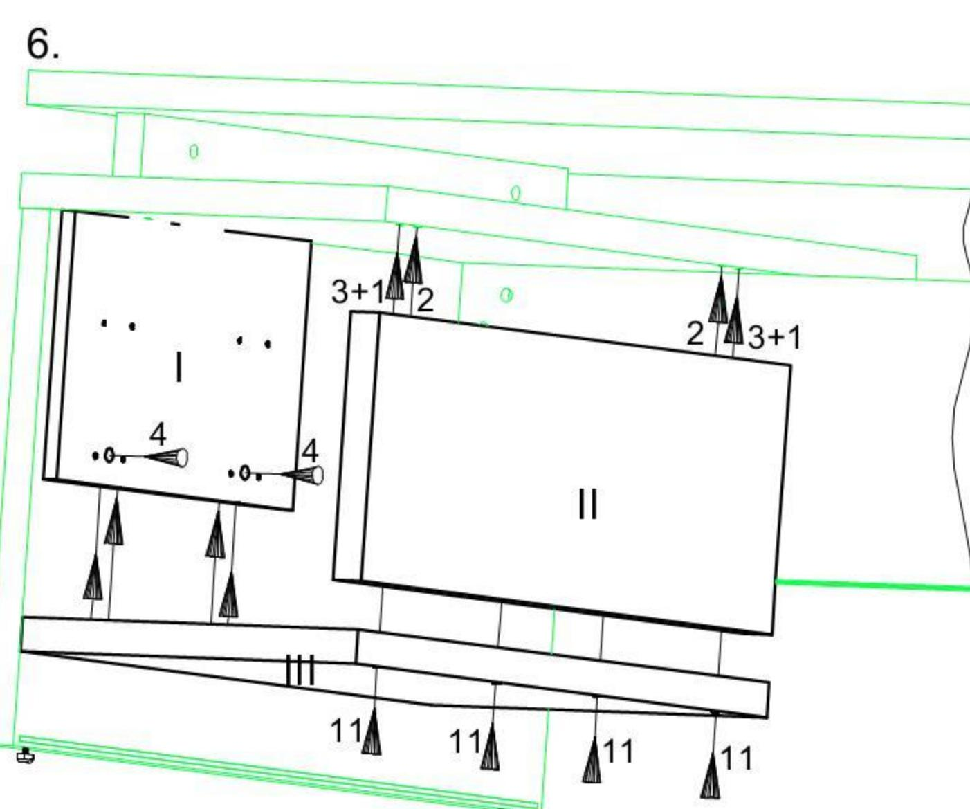
Установить ящики в корпус тумбы. Если требуется, вынуть ящики и отрегулировать их положение, сместив направляющие или вставив между боковинами и направляющими шайбы (10).
