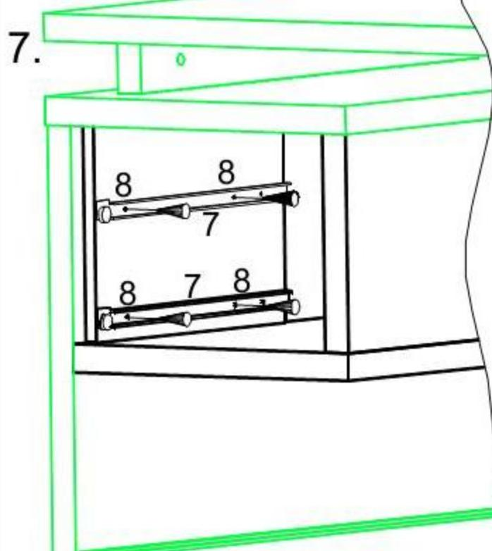
Прикрутить вторую пару направляющих (7) к внутренней боковине (I) винтами (8) (рис 7). Шляпки стяжек-эксцентриков закрыть заглушками (5), изнутри тумбы, стяжек (11) заглушками (13) на нижней полке.
