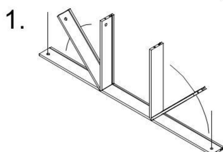
Собрать ящики. В фолдинги вставить шканты(2) и стяжки-эксцентрики (17). Согнуть фолдинги, установить в продольный паз фолдинга дно ящика. В переднюю панель вкрутить дюбеля(3). Присоединить переднюю панель (I) и затянуть отверткой стяжки-эксцентрики (17) на боковых панелях .
