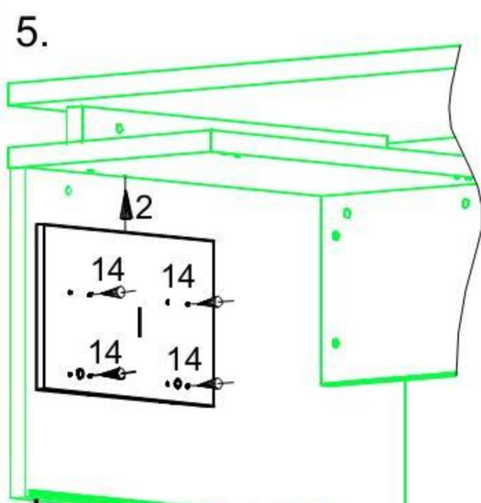
В торец внутренней боковины вставить шкант (2), предварительно нанести клей в отверстия Ø8 мм. Саморезами (14) прикрутить внутреннюю боковину к боковине стола (рис. 5).
