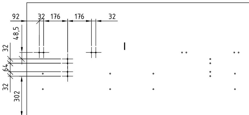
2. Вариант установки полки слева
