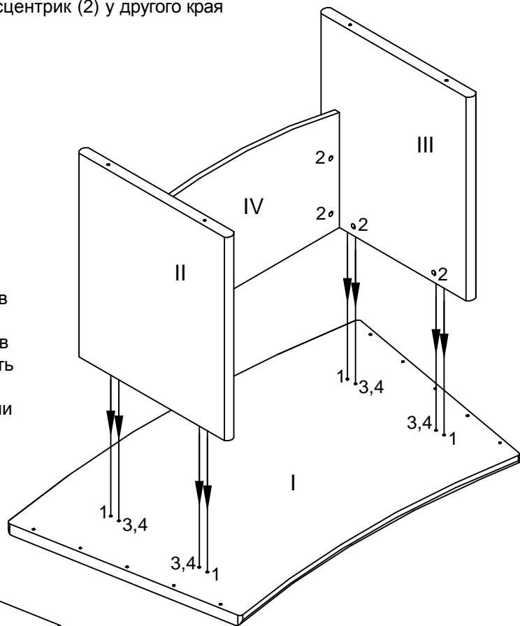
Положить столешницу отверстиями вверх. Забить в столешницу шканты (1) и цанговые футорки (4). Вкрутить в цанговые футорки дюбеля (3) до упора в обод. Присоединить к столешнице каркас и затянуть отверткой стяжки-эксцентрики (2) на боковинах. Закрыть торцы стяжек-эксцентриков декоративными заглушками. Поставить стол.
